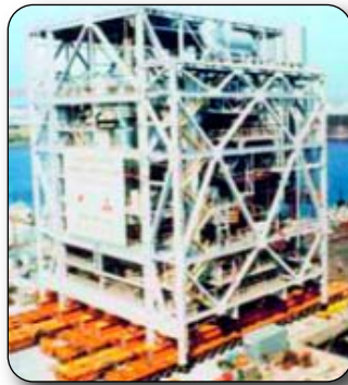
Sistema semovente modulare (committente Nippon Express)
